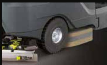
Ruote superelastiche anteriori e posteriori per ridurre al minimo le sollecitazioni aumentando il comfort
