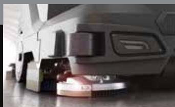
La terza spazzola laterale aumenta le performance di pulito lungo le pareti (disponibile nelle versioni MMg a disco)
