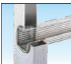
Gradino anti-scivolo mm. 30 x 30 Unito al montante verticale con doppia bordatura interna ed esterna per garantire la massima solidità e la lunga durata nel tempo
