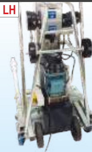
Elevazione elettrico-idraulica 230 V con leve di comando
