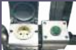
Presa elettrica da 230V posizionata sul cestello
