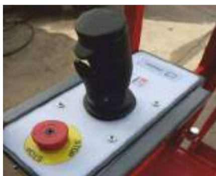
Comandi e indicatori sul cestello movimentazione con joystick
