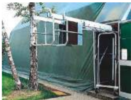
Scala ripiegata per il passaggio attraverso le porte
