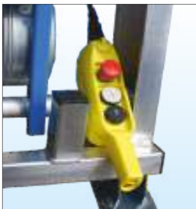
Elevazione a comando elettrico con pulsantiera di azionamento
