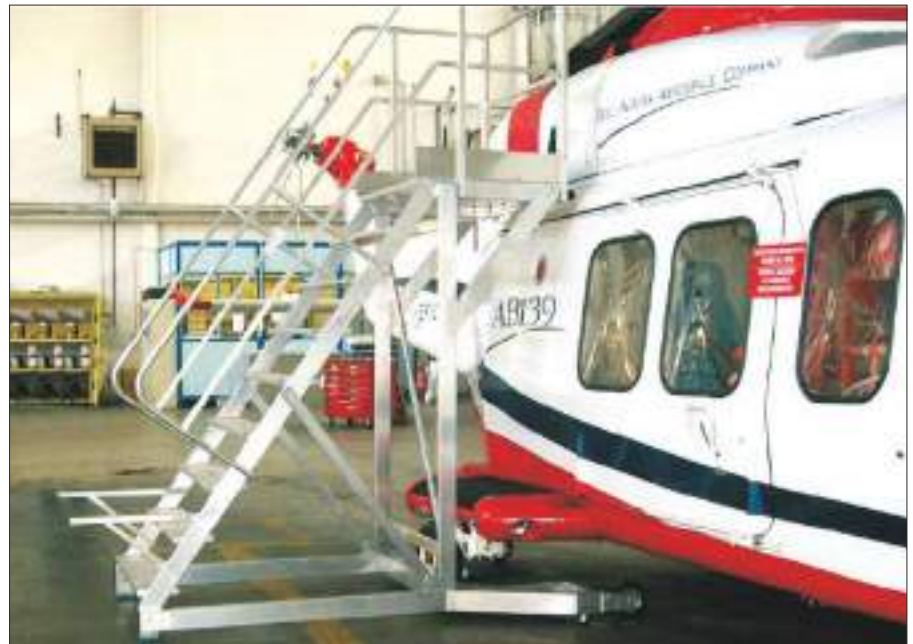
Scala a palchetto in vetroresina isolante
