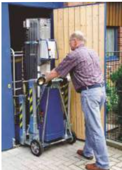
Zavorramento al telaio base per l'uso di stabilizzatori corti
