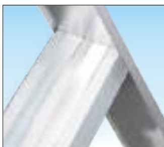
Gradini profondi 83 mm. molto robusti saldati su spessori maggiorati Unito al montante verticale mediante robusta saldatura ad angolo nascosta alla vista a garanzia della massima stabilità e di lunga affidabilità nel tempo
